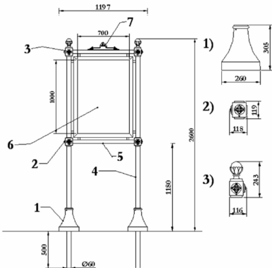
Stendardo di altezza finita 260 cm e larghezza finita di 120 cm, in fusione di ghisa, alluminio ed acciaio, tipo ST 70 della CITTAREDO o similari.
