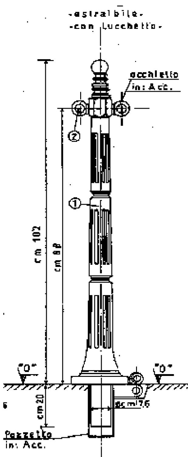
Dissuasore stradale di altezza finita 102 cm, con anelli per passaggio catene, del tipo estraibile a sezione tronco conica in fusione di ghisa ed anima in acciaio, tipo MAYO della CITTAREDO o similari.
